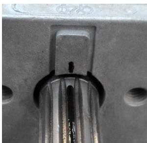
5-) Привод соединен с клапаном болтом с помощью соединительного блока.
